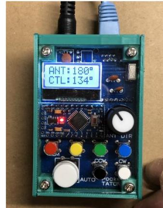
2) この状態で、右回転させる場合は、⑤ 手動右回転ボタン (CW) を押します。押している時間だけローテーターは右回転します。
