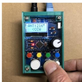
3) 左回転させる場合は、⑥ 手動左回転ボタン (CCW)を押します。押している時間だけローテーターは左回転します。
