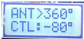
~~現在が、±180°表示の場合は、「ANT>360°」と1秒間表示され、次に0° ~ 360°表示に変換されたアンテナ角度表示に変わります。~~
