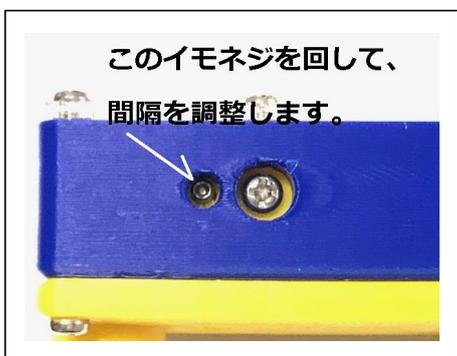
次に、両サイドにある穴奥のセットスクリュー（イモネジ）を回して接点間隔の調整を行います。
