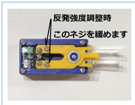
反発強度の調整を行うときは、まず左写真が示すネジを回して固定ネジを緩めます。
