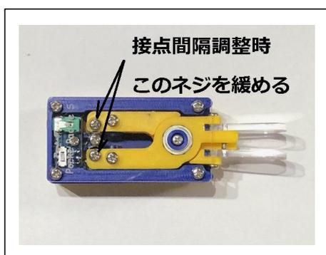
接点間隔の調整を行うときは、まず左写真が示すネジを回して固定ネジを緩めます。
