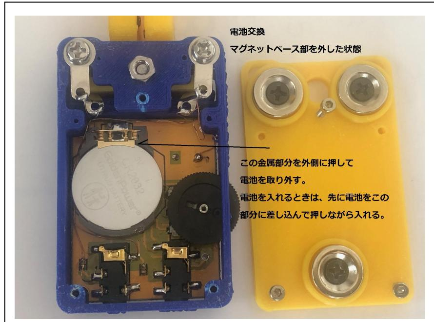
電池ホルダーの金属部分を押しながら電池を取り外します。
