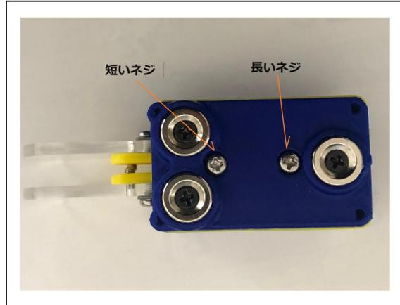
上部のネジ5本を外し下部ネジ2本を外し、パドル部を取り出します。
