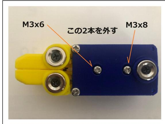
上部のネジ5本を外し下部ネジ2本を外し、パドル部を取り出します。
