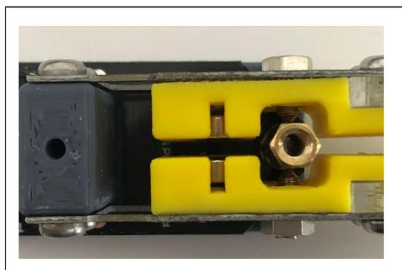
①の写真で示したセットスクリューで好みの反発力に調整します。
