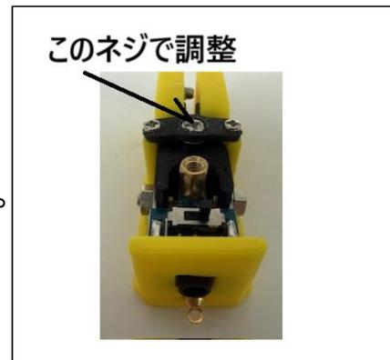
＜パドル反発力調整＞反発磁石間隔の調整
