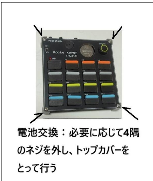
トップカバーを付けたままでの交換も可能ですが、必要に応じてトップカバーを外して交換します。
