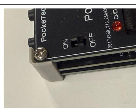
その次に Top カバーを載せて、ネジで固定します。
